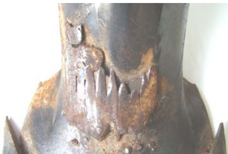
Рис. 2. Наличие сквозного протирания лапы на заплавленном участке крепежной области
