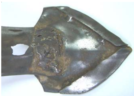
Рис. 3 . Сквозное протирание (в двух местах) лапы с ранее заваренным отверстием
