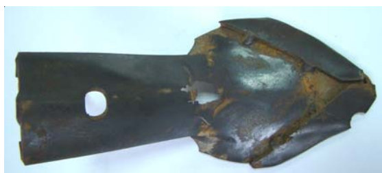
Рис. 7. Лапа, содержащая дефекты в совокупности - трещина + излом носка + протирание крепежа
