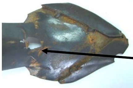
Рис. 5. Лапа с трещиной в области крепежа (стрелкой указан дефект)
