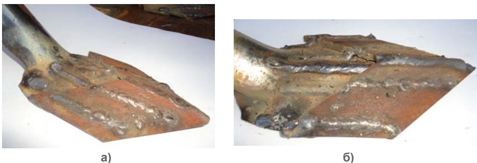
Рис. 2. Восстановление, с упрочнением компенсирующего элемента и лапы, нанесением валиков, параллельно траектории ее перемещения: а – шаг наплавки 20 мм, б – шаг наплавки 30 мм с охватом кромок детали
