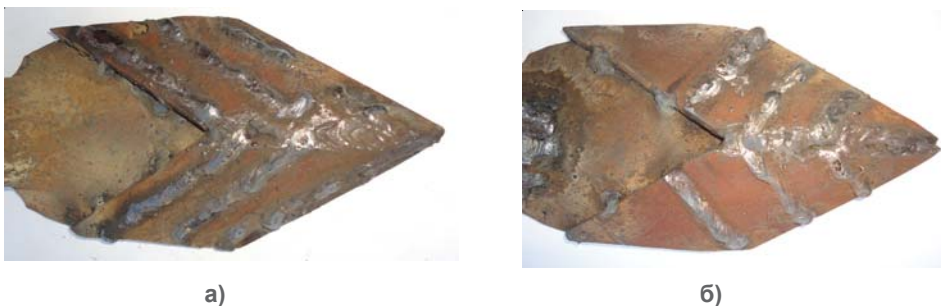
Рис. 1. Восстановленная лапа, упрочненная нанесением валиков: а) параллельно внешнему периметру, б) перпендикулярно внешнему периметру
