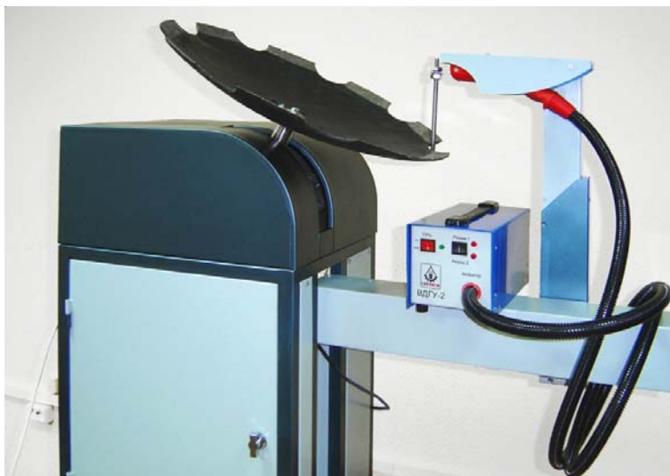
Рис. 4. Автоматизированная установка для упрочнения дисков вибродуговой наплавкой металлокерамики
