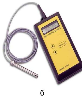
Рис. 2. а) соотношение водосодержания (water ppmw) и водонасыщения (saturation) в зависимости от температуры масла: с водонасыщением более 50% при 40°C вода выделяется из масла; б) - прибор WS04 фирмы «PALL» для контроля водонасыщения органических жидкостей в зависимости от их температуры
