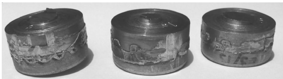
Рис. 5. Образцы после испытания на срез
