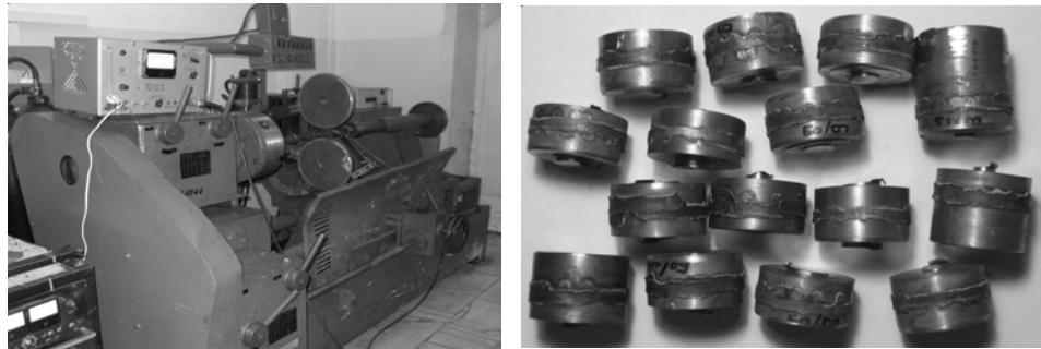
Рис. 2. а - установка ЭКП 01-11.022М; б - образцы после приварки покрытия (один виток)
