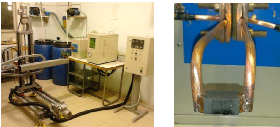
Рис. 4. Установка с манипулятором и индуктор для наплавки и борирования
