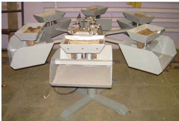
Рис. 8. Установка карусельного типа для наплавки грунтозацепов траков гусениц
