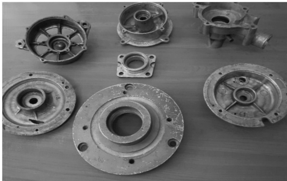
Рис 2 Детали восстановленные электроискровым легированием электродами-инструментами из сплава АО20-1.
