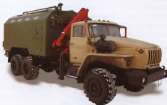
Рис. 2. Мастерская ММПУ на шасси Урал-4320 с краном-манипулятором БАКМ-890 (грузоподъемность манипулятора на вылете стрелы, кг: 5,4 м – 1650; 2,1 м – 4000)
