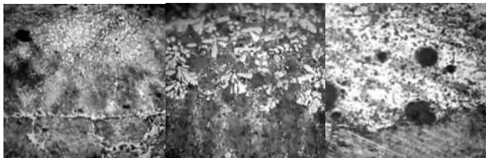
Рис. 1. Структура боридных покрытий на стали 65Г [7], полученных за 1 мин из различных смесей (400×): а. - Ia, б. - II, в. - IIIa
