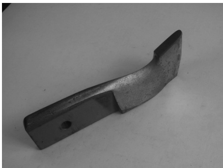
Рис. 1. Характерный износ долота
