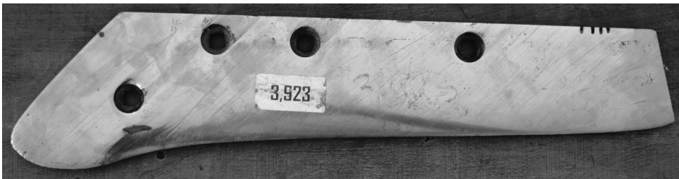
Рис. 2. Характерный износ опытного лемеха для плуга фирмы Lemken
