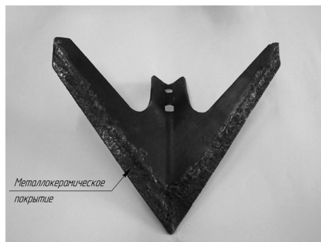
Рис. 5. Стрельчатая лапа культиватора КШУ-12Н, восстановленная и упрочненная по предлагаемой технологии
