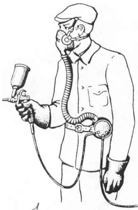
Рис. 1. Применение респиратора с подачей чистого воздуха под маску улучшает условия труда маляра
