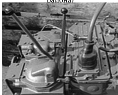
Рис. 6. Ремкомплект, восстановленный из агрегатов утилизируемых комбайнов ДОН, пригодный для дальнейшего использования (ООО «Агрофирма Луч» Динского района)
