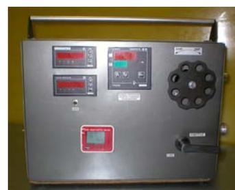
**6. Дроссель гидравлический ДР-350М** предназначен для определения объемной подачи и коэффициента подачи насосов гидросистем тракторов и самоходных
