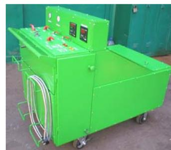
**5. Универсальный гидротестер КИ-28240** предназначен для безразборного диагностирования гидравлической системы тракторов и с.х. машин
