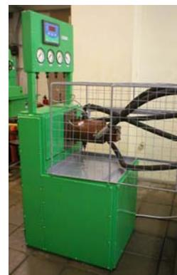
**3. Приставка к стенду КИ-28097М** для испытания гидроагрегатов рулевого управления (насосы-дозаторы: НД-80; НД-120; НД-125; предохранительно-переливные клапаны КН-50; гидроцилиндры рулевого управления: ГЦ-63; усилители потока (золотниковые): УП-120; гидроусилители рулевого управления тракторов МТЗ, Т-40А, ЛТЗ-55, К-701, К-700А, Т-150К; гидрораспределители с электронным управлением комбайнов и кормоуборочных машин)
