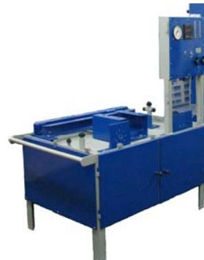
**4. Мобильная моечная установка КИ-28241** предназначена для оперативной промывки и очистки гидросистем тракторов и самоходных с.х. машин
