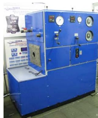
**2. Приставка к стенду КИ-28097М** для испытания агрегатов гидростатической трансмиссии ГСТ-90; ГСТ-112-1; ГСТ-112Б-1; НП-112-1; МП-112Б-1 и др.
